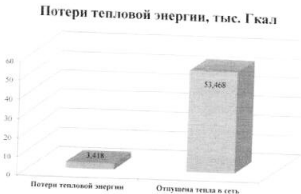
Рис. 1.2. Потери тепловой энергии на 2015 г.
