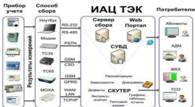
Рисунок. Структура системы диспетчеризации
